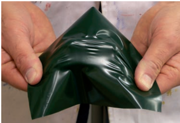
Höchst elastisch: durchgetrocknete GORI 55 Beschichtung im Belastungstest auf einer Kunststoffolie
